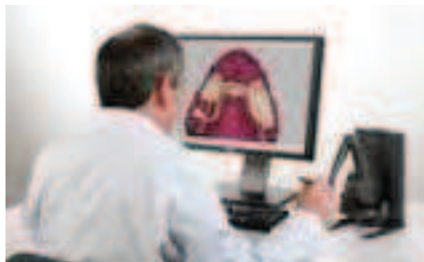
Figure 2–12 : Illustration d'un EVAH non colocalisé (exemple du système Sensable Dental Lab System)
