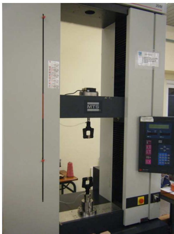
Figure 49 : Photographie Machine de tests de traction MTS 100 M
