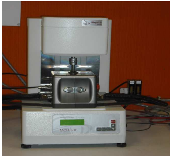
Figure 37 : Rhéomètre MCR500 de PHYSICA
