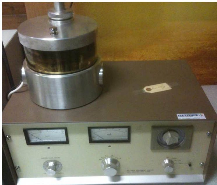
Figure 89 : Photographie d'un métalliseur Polartron 5100
