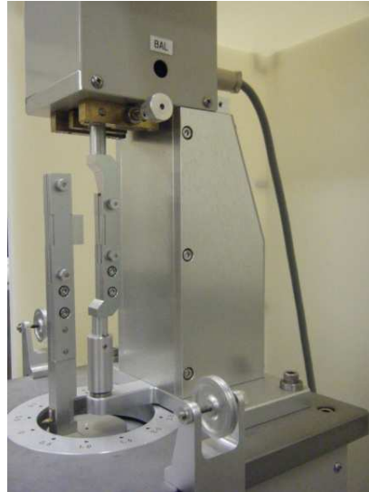
Figure 80 : Photographie du dispositif KES-SH utilisé pour les tests de flexion
