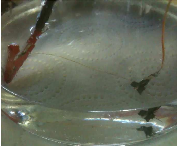
Figure 90 : Photographie d'un échantillon plongé dans un bain d'huile de silicone lors de la polarisation
