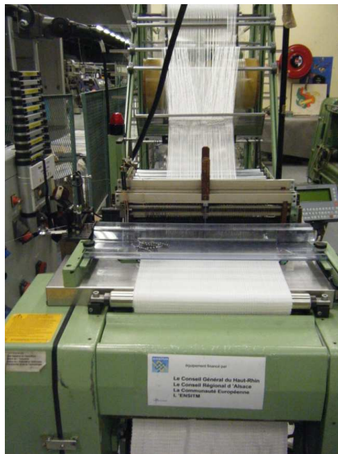
Figure 103 : Machine de tissage industrielle (MULLER NCE 10)
