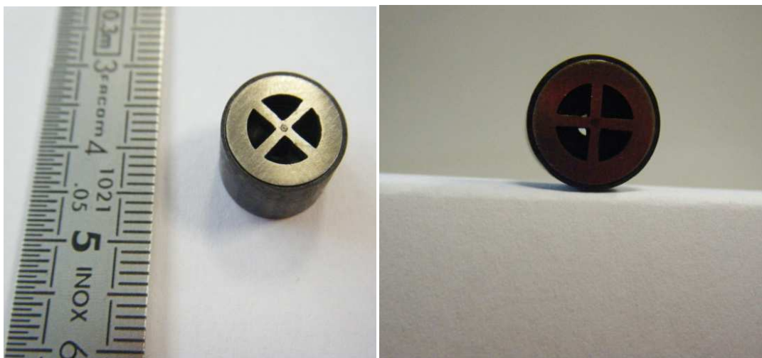
Figure 69 : Photographie de la filière bi-composants après assemblage
