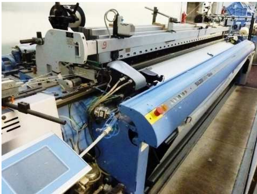
Figure 5 : Photographies d'une machine à tisser jet d'air de marque Sulzer G6500
