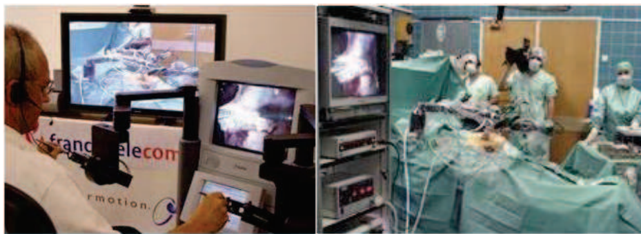
Figure 1.1. Commande du Système ZEUS (gauche) et manipulateurs robotisés (droite) [IEEEspec, www].
