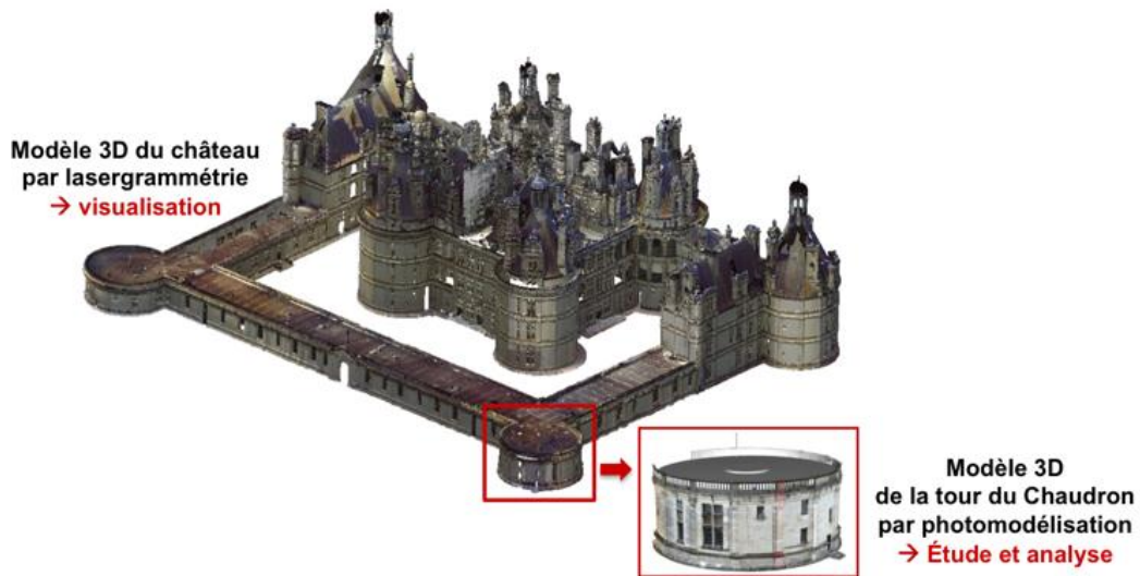
FIGURE 109 : COMBINAISON DES DEUX METHODES DE MODELISATION 3D A DES FINS DE VALORISATION DU TRAVAIL SCIENTIFIQUE
