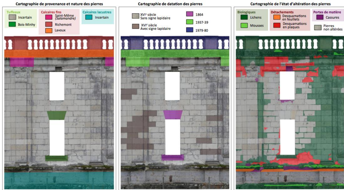
FIGURE 71 : CARTOGRAPHIES DE PROVENANCE, DE DATATION, ET DE L'ÉTAT D'ALTERATION DES PIERRES DE LA TRAVÉE N°9
