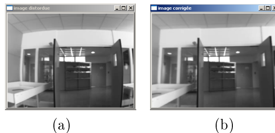
Figure 2.2: Exemple de correction de la distorsion : (a) une image distordue (b) l'image après la correction de la distorsion
