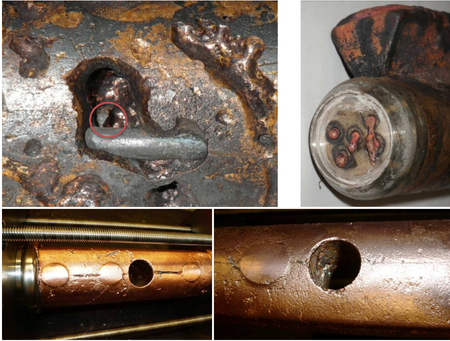
FIGURE 5.4 – Grossissements des défauts des deux maquettes : (en haut) lingotage et (en bas) demi-coquille.
