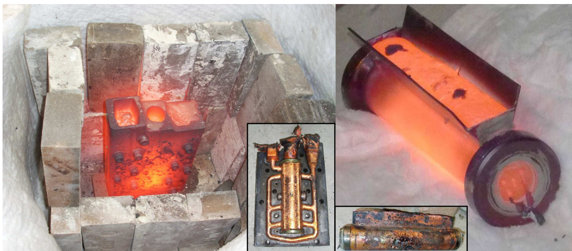
FIGURE 5.3 – Refroidissement du cuivre en fusion dans les moules et maquette après démoulage. A gauche, moule demi-coques. A droite, moule lingotage.
