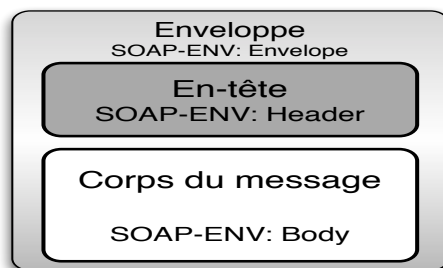
FIGURE 2.1 – Structure d'un message SOAP
