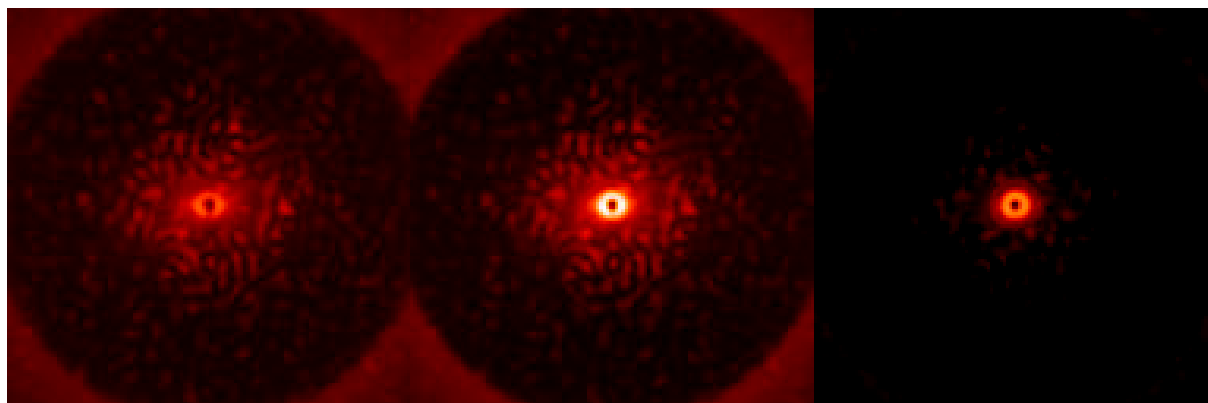
FIGURE 4.8 – Évolution des tavelures avec la longueur d'onde. Avec la même dynamique : [gauche] image à 950 nm remise à l'échelle à 1650 nm et multipliée par le coefficient \gamma , image à 1650 nm [centre] avant et [droite] après la soustraction des tavelures. Le gain sur la valeur RMS après la soustraction est de 2.5.
