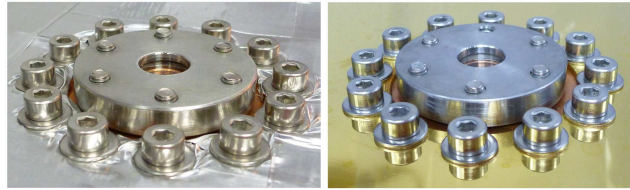
FIGURE 3.21: Photographie du dispositif de montage des fenêtres. On notera la grande densité de boulons afin d'assurer au mieux le contact thermique cuivre/verre.
