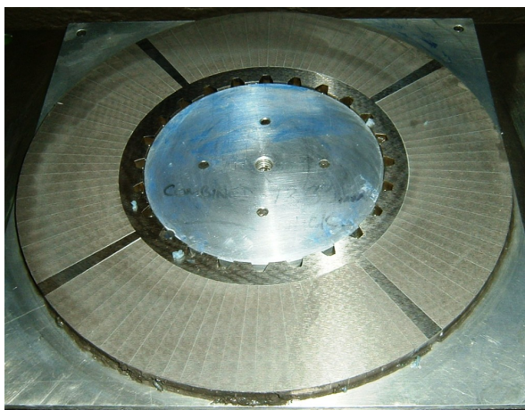
(a) Vue avant le collage de la couche de friction en inox
