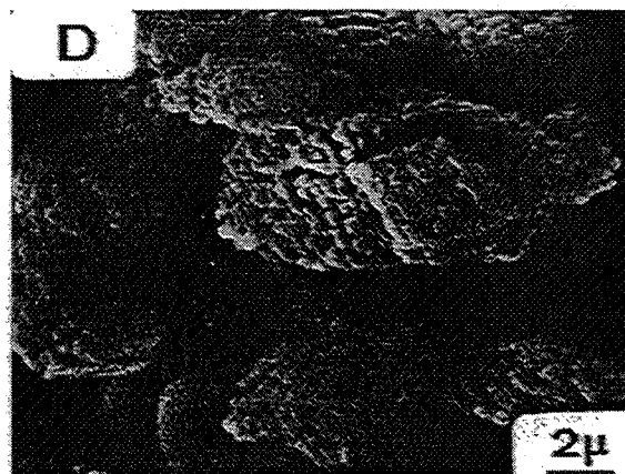
Figure I.15 : Décomposition de calcite à 780 °C sous 50 Pa de dioxyde de carbone jusqu'à \alpha=0,5 [61]
