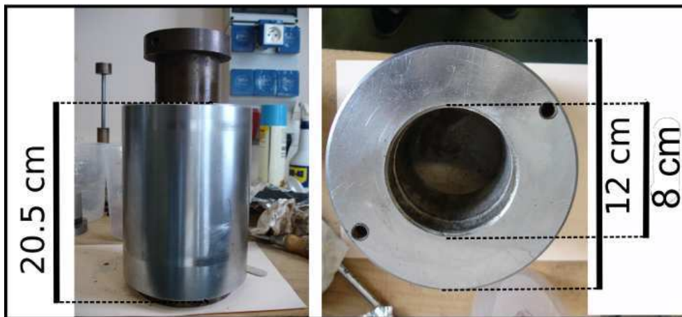
FIG. 1.2 – Cellule oedométrique utilisée pour la compression des poudres
