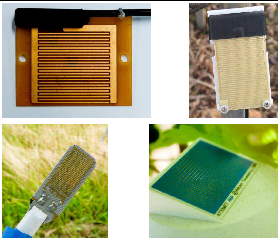
Figure B.26 - Capteurs de durée d'humectation à mesure de résistance électrique. a. capteur Campbell Scientific 237 ; b. capteur Connecting Nature ; c. Capteur Cimel CE 187A ; d. capteur Adcon Telemetry A733 .
