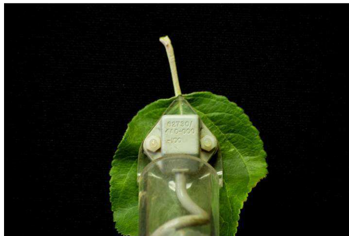
Figure A.2 – Mesure des angles d'Euler à la base de la nervure principale d'une feuille de pommier
