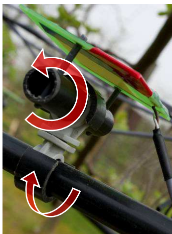
Figure IV.5 – Détail des fixations d'un capteur de durée d'humectation et ses degrés de liberté
