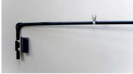
Figure IV.3 – Bras de support des capteurs de durée d'humectation avec les anneaux mobiles de fixation
