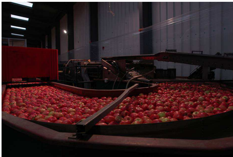
Figure B.1 – Chaîne industrielle de calibrage et colorimétrie de pommes dans un entrepôt de traitement après récolte, pour trier les pommes par qualité de couleur et taille
