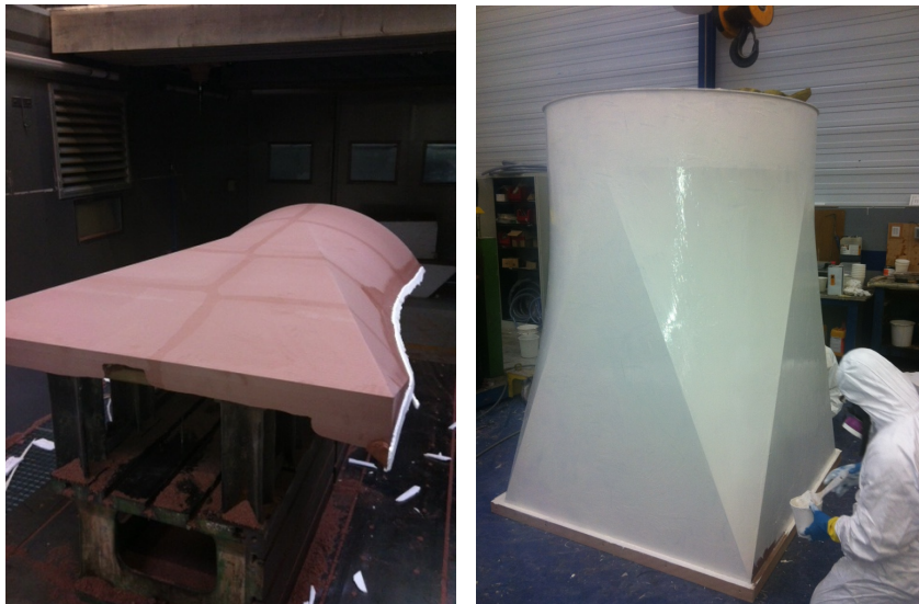
(a) Photographie du quart de moule utilisé pour la réalisation des diffuseurs
