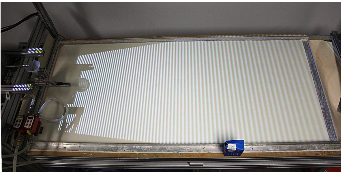
FIGURE 12.6 – Calibration de la surface de référence avec du lait.
