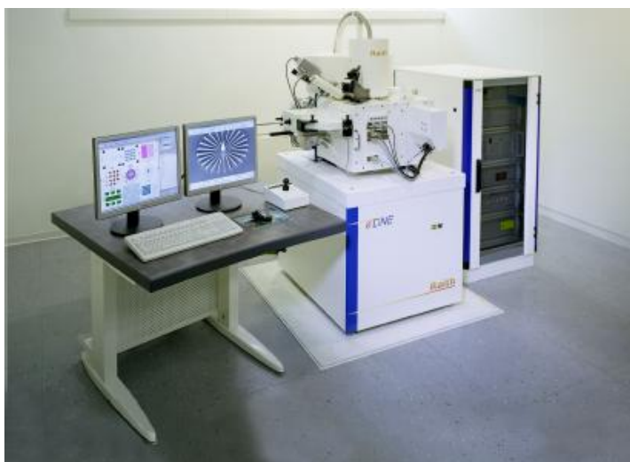
Figure 2-1 - Photo de la station Raith e_Line permettant d'insoler des résines électrosensibles, installée au sein de la centrale de technologie de l'institut FEMTO-ST.
