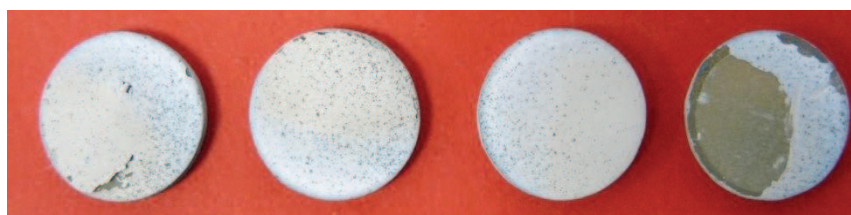
Figure VI - 9 - Macrographie des substrats PWA-1483 revêtus selon Particoat après 250 cycles de 1h à 1100°C.
