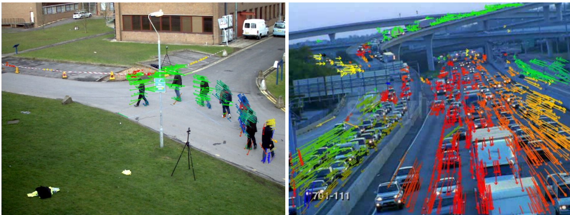
FIGURE 2.7 – Illustration des vecteurs obtenus grâce à l'algorithme de calcul du flux optique
