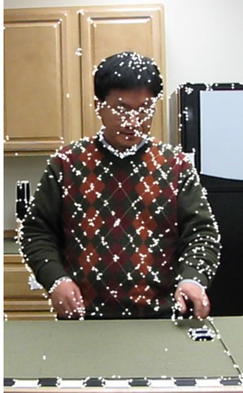
FIGURE 2.5 – Exemple de points d'intérêt extraits avec le détecteur de Harris
