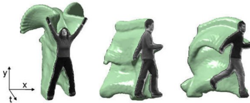
FIGURE 2.9 – Illustration d'un volume spatiotemporel obtenu suite à l'empilement de silhouettes à travers le temps
