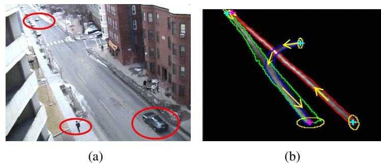
FIGURE 2.14 – Illustration de l’approche de Wang et al. [WTG06], (a) détection et suivi d’objets pour estimer les trajectoires, (b) motifs de mouvement estimés
