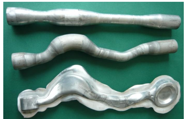
Figure 12 - Bielle de direction, préforme obtenue par laminage transversal [IWU Chemnitz]
