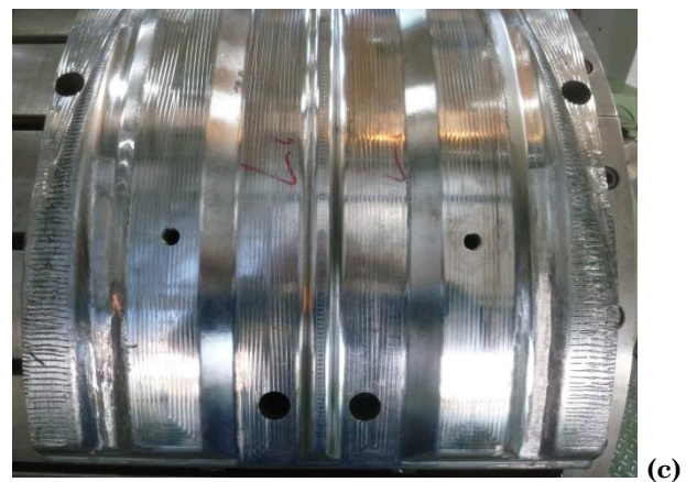
Figure 108 - Vue des segments de matrices circulaires [IWU Chemnitz]
