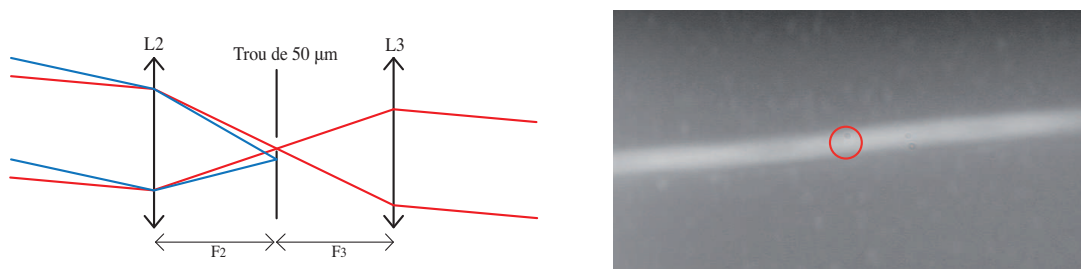
FIGURE 2.20 : (a) Système confocal sélectionnant les rayons les moins inclinés (rayons rouges) provenant d'un disque de 1 \mu\text{m} de diamètre sur la surface de l'échantillon. La zone de l'échantillon observée est la région entourée sur l'image (b).
