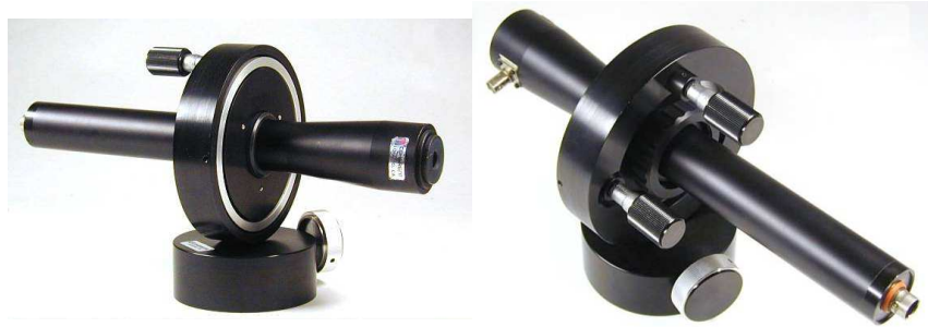
FIGURE 2.21 : Interféromètre de Fabry-Pérot SA-800 de la marque Burleigh dans son support, avec deux vis de réglage d'orientation, la cavité et une diode qui reliée à un oscilloscope permet d'effectuer les réglages fins.
