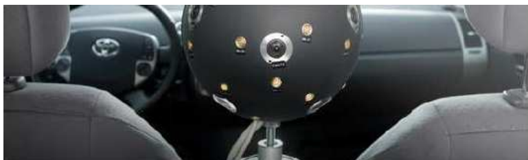
FIGURE 1.4 – Formation de voies avec une antenne sphérique (Caryer Cook [23])
