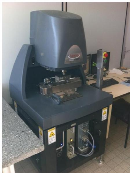
Figure II. 16. Topomètre 3D (Interféromètre optique).
