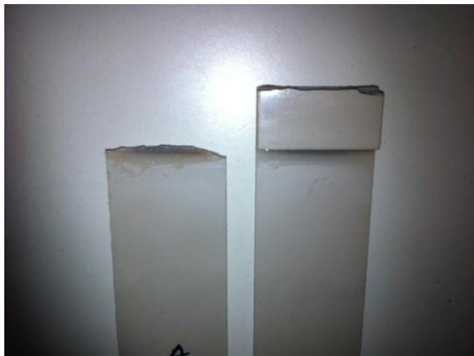
Figure IV. 17. Rupture d'éprouvette PEEK90G dans le substrat.
