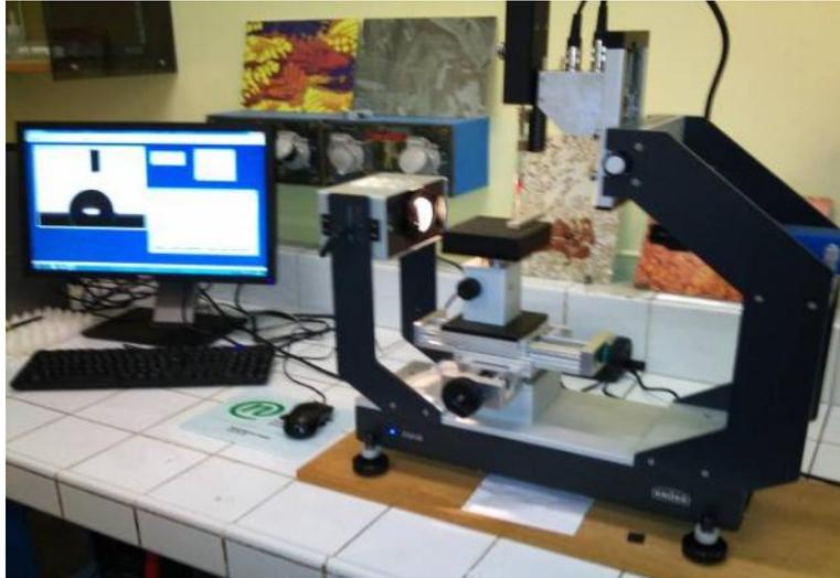
*Figure III. 9. Dispositif expérimental de mesure d'angle de contact.*
