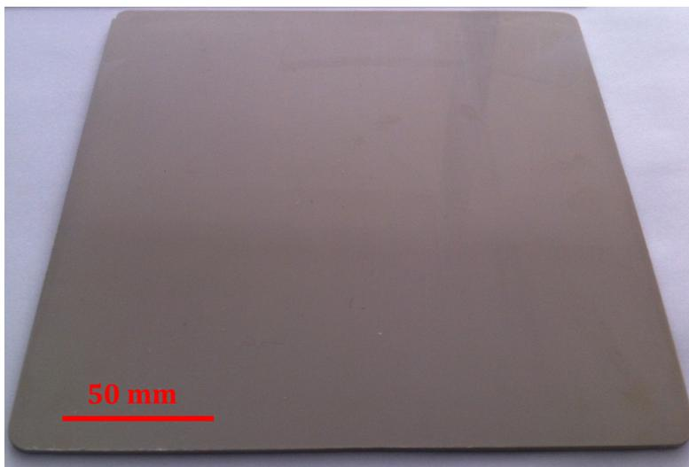
*Figure I. 16. Plaque injectée du PEEK 90G.*
