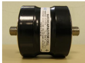
FIGURE III-1 : CELLULE DE SUPERCONDENSATEUR (B650F)
