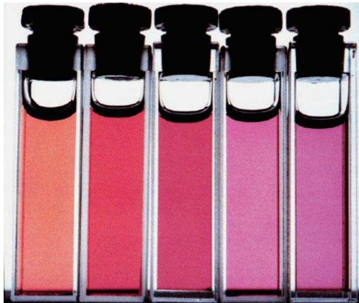
Figure 18: Effet de l'indice de réfraction sur la position de la bande plasmon ( $n = 1.336, 1.407, 1.481, 1.525$  et  $1.583$  respectivement [20]).
