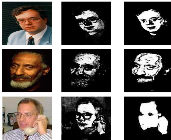
FIGURE 3.5 – Des entrée (première colonne à gauche) et des sorties de deux détecteurs de peau fondés sur deux types d'arbres de dépendances à bi-probabilité. Les images aux niveaux de gris de la deuxième et de la troisième colonne correspondent respectivement à celles du détecteur fondé sur l'arbre Simple et celui basé sur le Meilleur Arbre Recouvrant.
