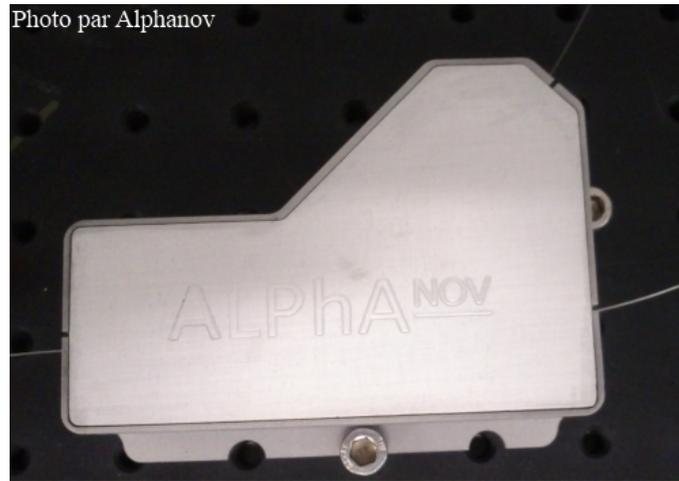
FIGURE 2.62 – Image du système de pompage optique intégré. Ses dimensions sont de 100 mm × 70 mm × 30 mm. Nous pouvons voir les fibres de pompage optique, active et d'extraction du signal amplifié.
