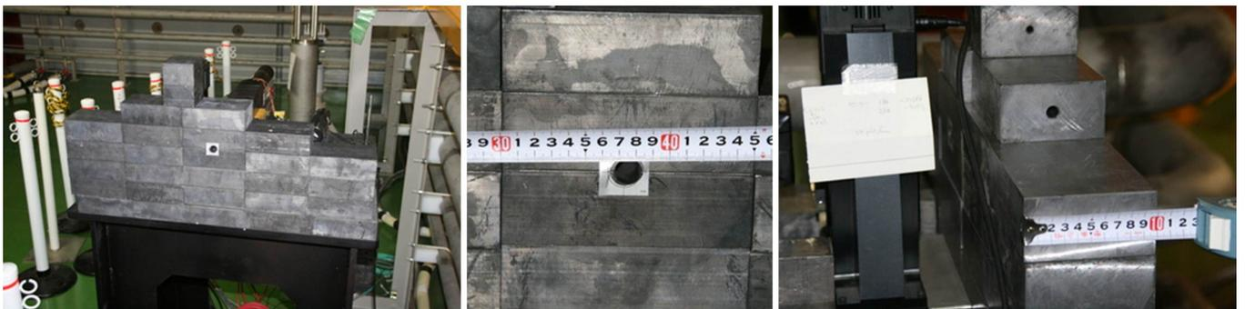
FIGURE 4.33 – Images du second collimateur situé à 20 m du point d'interaction devant le détecteur et constitué d'un mur de plomb de 10 cm d'épaisseur avec un trou de 2 cm de diamètre.
