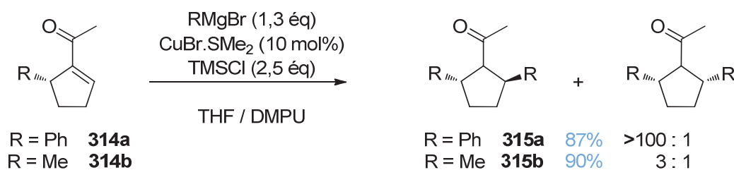
Schéma III-147 : addition conjuguée par un réactif de Grignard
