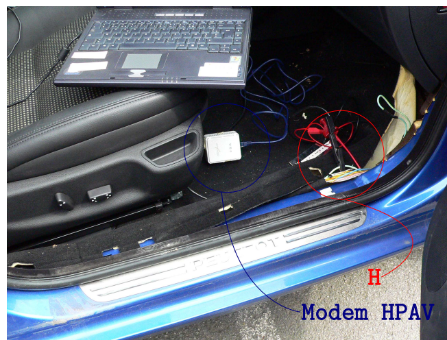
(b) Photographie d'un modem HPAV installé au point H d'une Peugeot 407SW essence
