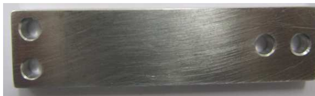
FIGURE 7.23 – Lame métallique utilisée pour le réglage de l'orientation de la parabole autour de son axe.
