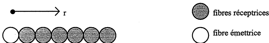
Figure cg1 : schéma d'un nouveau capteur pour la détermination d'une distribution granulométrique
