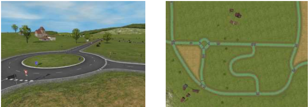
FIGURE 1.5 – À gauche la représentation graphique d’une base de données. À droite, la même zone en vue simplifiée, incluant en surimpression la représentation des éléments logiques de l’environnement, qui seront visibles par les véhicules autonomes : voies, panneaux, présence d’une intersection. . .
