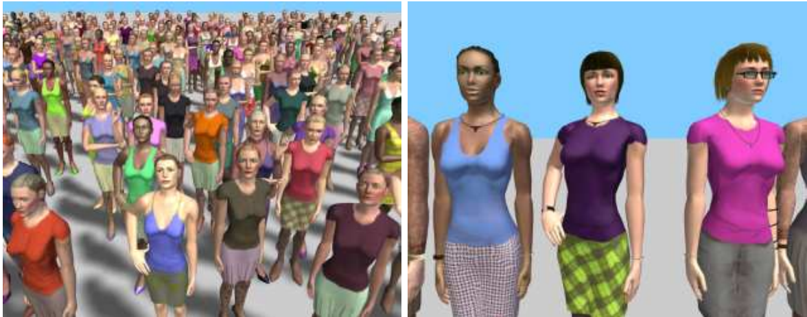
FIGURE 1.14 – À partir du même template graphique, l’application de couleurs de peau et d’accessoires différents (vêtements, lunettes, cheveux. . .) permet d’obtenir une grande diversité visuelle pour un coût de calcul et de mémoire restreint (d’après [Maim, 2009]).
