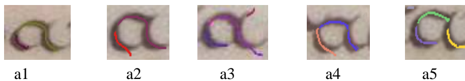
Figure 3.18. Exemple d'occurrences de la lettre « a » et leur segmentation pour le manuscrit 1 avec C = 3 et S_{M1} = 0,5
