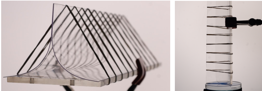
FIGURE 2.12 – Coin cubique, formé en appliquant deux plaques flexibles contre une plaque rigide à l'aide de rubans élastiques. À gauche, une vue de profil du coin. À droite, le coin plongé dans un bain liquide
