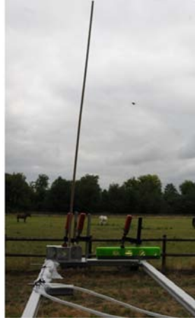
(a) Diamètre de la tige : 8 mm ; longueur de la tige : 960 mm ; vitesse de l'écoulement : 16,6 m/s ; vitesse du vent : 1,8 m/s (relevé Météo France).
