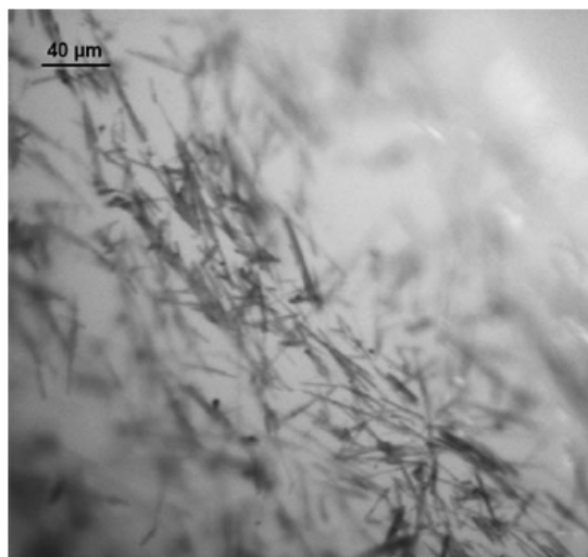
Schéma 3.27: observation au microscope, après centrifugation, du fer (0) contenu dans le catholyte après électrolyse au potentiel E = -1,7 \text{ V} 153 d'une solution contenant [\text{Fe}^{\text{III}}(\text{acac})_3] = 4 \text{ mmol.L}^{-1} et [\text{phen}] = 8 \text{ mmol.L}^{-1} .
