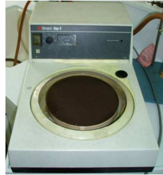
Figure II-19 : Photo de la polisseuse utilisée. La vitesse de rotation du plateau est de l'ordre de 25 tours/min
