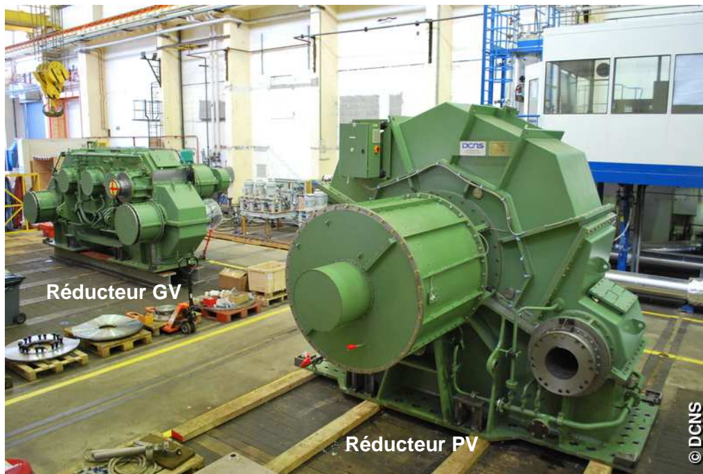
Fig. 2 – Réducteurs GV (grande vitesse) et PV (petite vitesse) de frégate.
