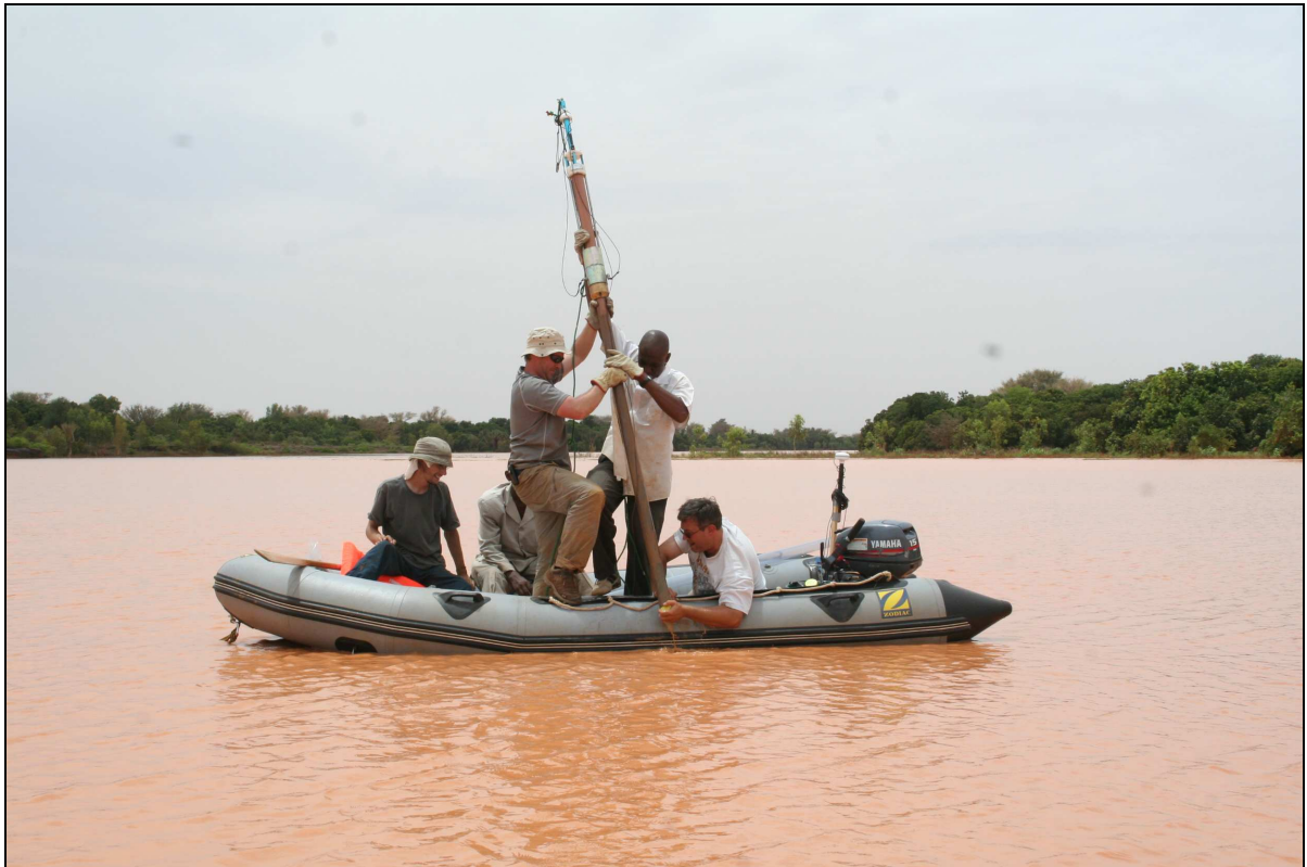
Figure 4.15 : Carottage dans le lac de Bangou Kirey avec le carottier UWITEC (Photo : Rajot, 2008)
