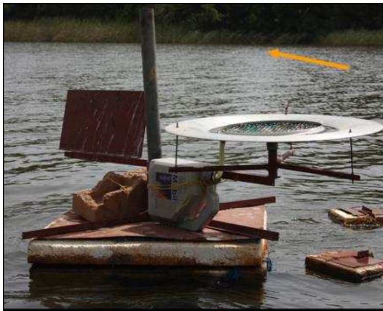
Figure 4.4 Collecteur de dépôt de poussière (Frisbee) sur Bangou Bi. La flèche indique la direction du vent au moment de la prise de vue (Photo : Mamane, 2009)
