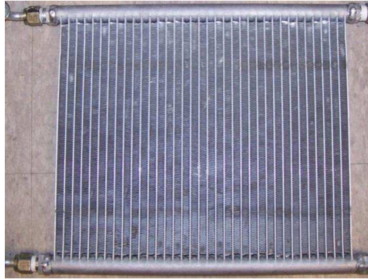
FIGURE 4.14 – Evaporateur à mini-canaux utilisé par Bielskus (2011)
