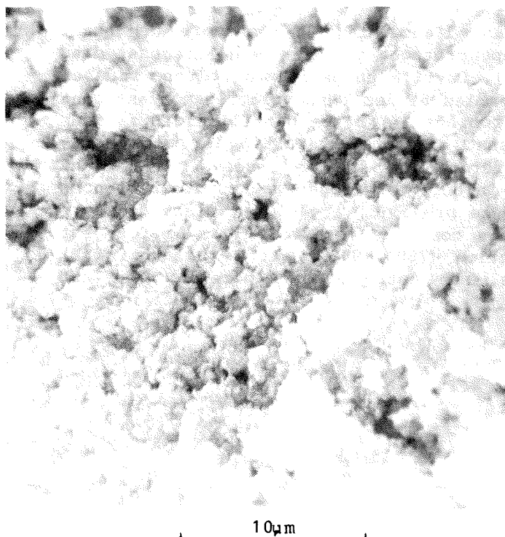
Figure 2g : Bore rhomboédrique alpha (13) obtenu par réduction de BBr_3 par H_2 ( \times 3500 ).
