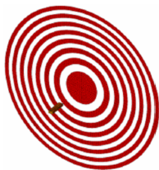
FIGURE 1.30 – Lentille de Fresnel à anneaux métalliques[51]
