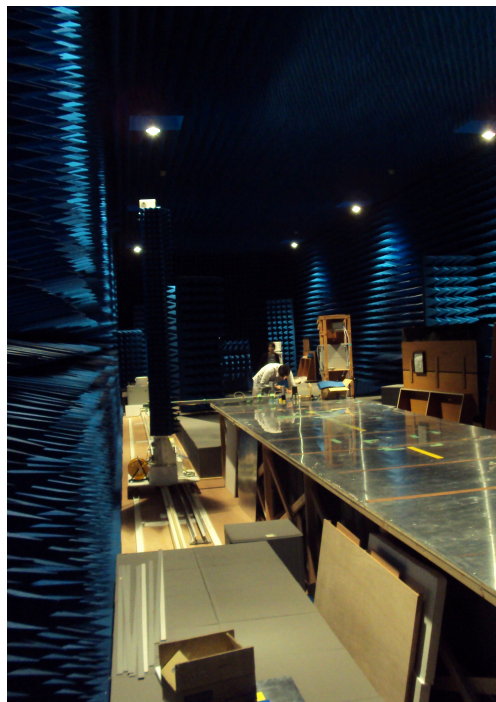
FIGURE 4.3 – Chambre anéchoïde de l'ENRI
