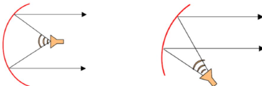
FIGURE 1.32 – Antennes à réflecteur simple centré et en 'offset'
