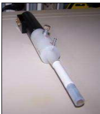
Figure 8 : Electrode tournante avec l'échantillon d'acier 304L.
