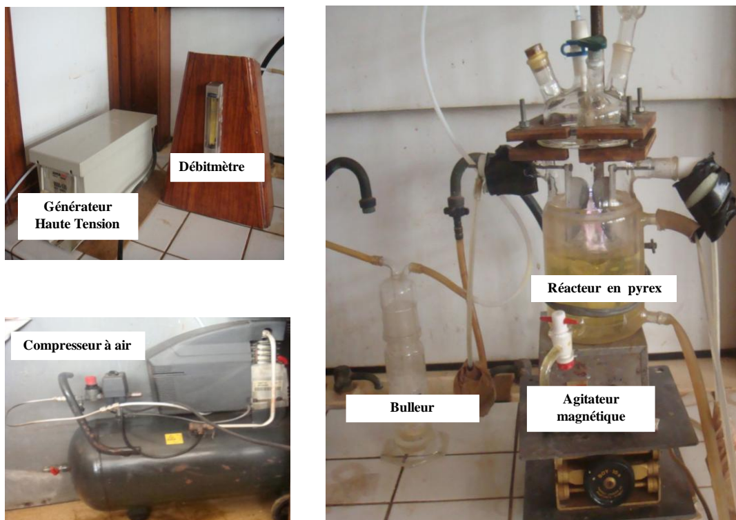
Figure III-10 : Dispositif expérimental du procédé Glidarc
