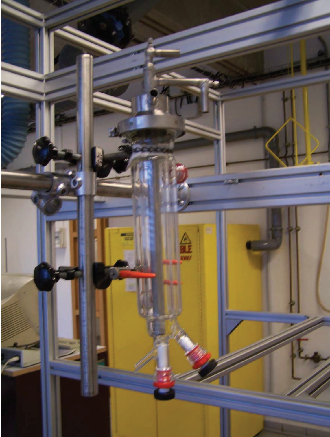
Fig. A.1 : Photographie du pilote expérimental composé du doigt de gant et une cuve en verre.
