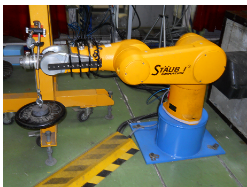
FIGURE G.2 – Bras TX90 tendu avec une charge de 13\text{ Kg} sur son effecteur.
