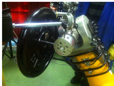
FIGURE G.8 – Configuration du robot et position de la charge lors de l'essai 2.3.
