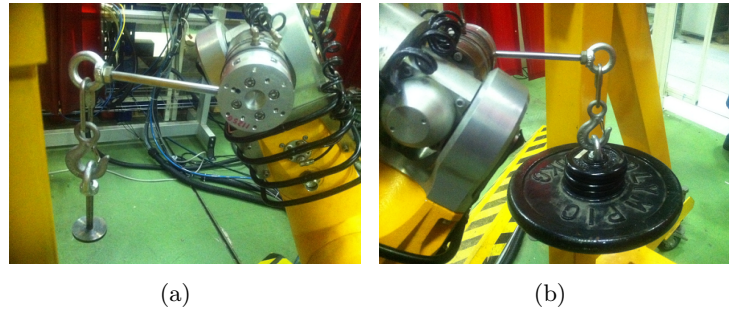
FIGURE G.5 – Position des masses par rapport à l'effecteur lors de l'essai 2.1.
