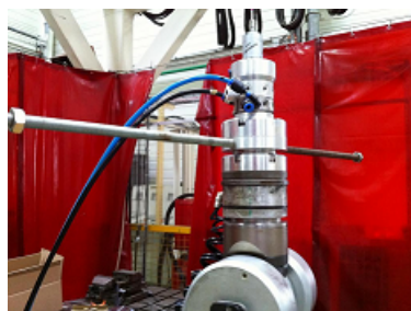
FIGURE 5.7 – Tige filetée porteuse des charges.
