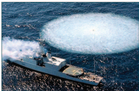
FIG. 1.1: Essai de choc sur navire (source : www.martec.com ).
