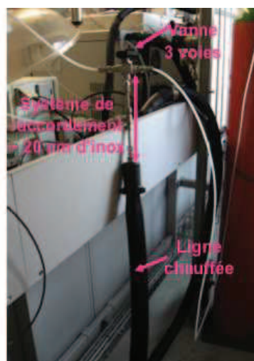
Photo 5 Système de raccordement en inox entre la vanne trois voies et la ligne chauffée
