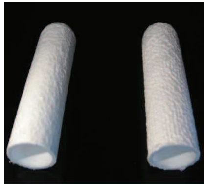
Photo 4 Filtres Horiba pour l'entrée de la baie FTIR et le préfiltre. Droite, filtre papier R. Gauche, filtre papier RH, utilisé lors d'expériences avec ammoniac
