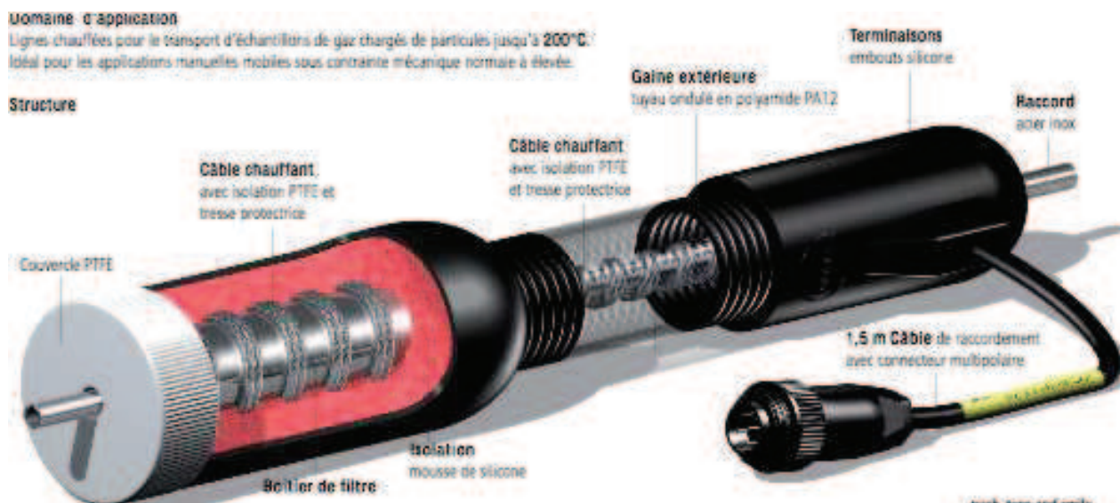
Figure 150 Ligne chauffée série WAF, avec boîtier de filtre chauffé intégré pour le transport d'échantillon jusqu'à 200°C (Source Winkler)
