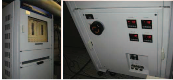
Photo 2 FTIR Horiba, gauche : écran et clavier de contrôle; droite : Réglages des températures des lignes, pompe et filtre, et zone d'emplacement du filtre à particules en papier.
