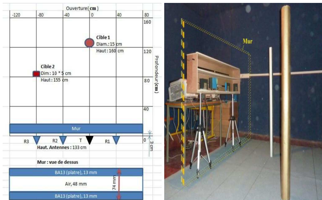
FIGURE 3.17 – Configuration de la scène de mesure (en haut) et photo de la salle de manipulation (en bas).(Le mur est enlevé.)
