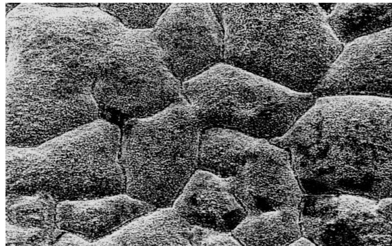
Fig. I.4 : Ancrage des joints de grains par \text{Cr}_2\text{O}_3 , oxydation différente en surface et à l'aplomb des joints d'après [37]
