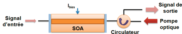
Figure 4-20 : Pompage optique autour de la transparence du gain dans le SOA avec une configuration contra-propagative.
