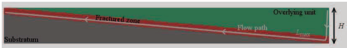
Figure 6-1: Impact de la profondeur de la zone fracturée sur les chemins d'écoulement.
